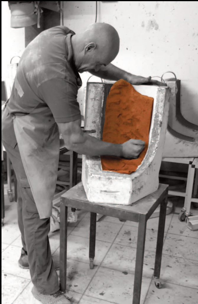
Leirmassen fylles i hver krok av formene. Dette gjøres for hånd.
